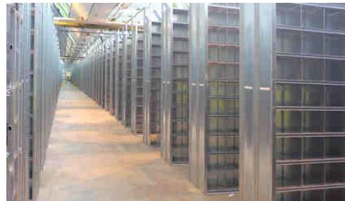
HI280 tillverkas i en helautomatisk produktionslinje av varmgalvaniserad stålplåt vilket ger en produkt med hög och jämn kvalitet. Konstruktionen bakom HI280 bygger på principen med minmalt antal komponenter.
