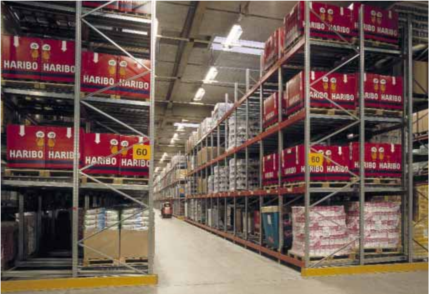
PALLETFLO i push-back-lager. Produkter med snabb omsättning, såsom specialerbjudanden och kampanjprodukter, lagras i ett LIFO-lager.
