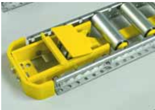
Fotpedalen frigör separatorn och matar fram nästa pall, kan erhållas vid förfrågan.
