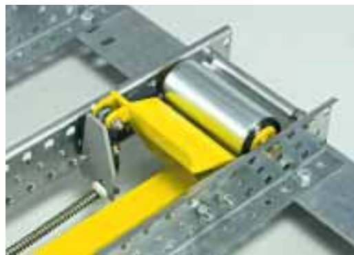
Fotpedalen frigör separatorn och matar fram nästa pall, kan erhållas vid förfrågan.
