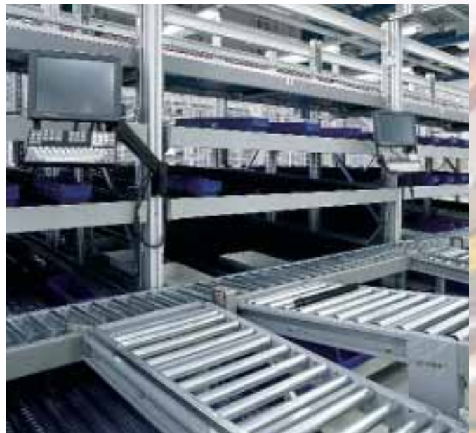
Ovanstående SELECTAFLO-anläggning, som är en integrerad del av lagersystemet, hanterar utan vidare upp till 20.000 order per dag.
